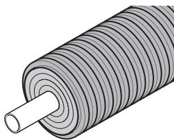
Теплоизолированные трубы Uronor Ecoflex Varia из сшитого полиэтилена РЕ-Ха в изоляции из вспененного полиэтилена, покрытой гофрированным кожухом, предназначены для тепло- и холодоснаб-
