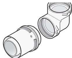
Система модульных фитингов Uronor RS предназначена главным образом для стояков и магистралей диаметром до 110 мм. Принцип модульности: необходимые фитинги собираются из
