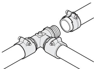
Зажимные фитинги Uropog Wipex предназначены для труб Thermo, Varia, Aqua, Quattro, Supra (Plus/Standard), используются в системах тепло- и холодоснабжения, холодного и горячего водоснабжения, канализации. Внутренняя резьба фитинга оснащена уплотнительным кольцом, не требуется уплотнение по резьбе. Для труб диаметром от 25 до 125 мм, серий S5,0 (PN6) и S3,2 (PN10).
