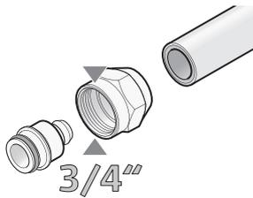
Фитинги и коллекторы Uni-X для подключения к трубам Уропог посредством зажимных адаптеров 3/4" Евроконус для систем отопления, охлаждения и водоснабжения.
