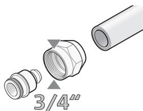
Фитинги и коллекторы для подключения к трубам Уропог посредством зажимных адаптеров 3/4" Евроконус для систем отопления и охлаждения.
