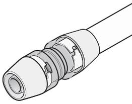
Фитинги Uronor RTM разработаны таким образом, что процесс монтажа практически полностью исключает необходимость использования какого-либо инструмента, при этом
