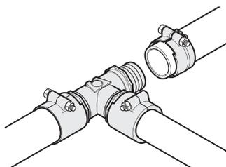
Зажимные фитинги Уропog Wiprex предназначены для труб из сшитого полиэтилена PE-Xa, используются в системах отопления и охлаждения, холодного и горячего водоснабжения. Внутренняя резьба фитинга оснащена уплотнительным кольцом, не требуется уплотнение по резьбе. Для труб диаметром от 25 до 110 мм, серий S5,0 (PN6) и S3,2 (PN10).
