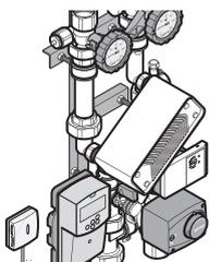
Насосно-смесительные блоки компании Uropog представляют из себя укомплектованные и предварительно собранные узлы управления расходом и температурой подачи в систему напольного
