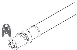
Проверенная временем система пресс-фитингов Uponor S-Press является отличным решением для создания надёжного соединения с многослойными композиционными
