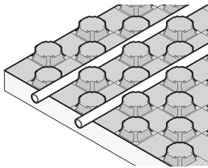
Панель для укладки труб Upronor Nubos специально разработана для установки напольного отопления/охлаждения в жилых и нежилых зданиях. Панели устанавливаются в полу под слоем цементной
