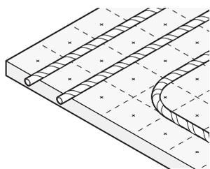
Система Klett предлагает инновационную технику укладки труб для напольного отопления и охлаждения. При производстве труба оборачивается специальной лентой-
