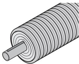
Трубы Uponor Ecoflex Supra PLUS и Supra Standard из полиэтилена высокой плотности ПЭВП с греющим кабелем в изоляции из вспененного полиэтилена, покрытой гофрированным кожухом, предназначены
