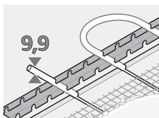
Система поверхностного отопления и охлаждения Upronog Fix для потолочной и настенной установки. Благодаря трубам PE-Ха 9,9 мм, интегрированным в слой штукатурки, действительно
