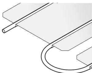
Система предназначена в основном для деревянных конструкций без стяжки.
