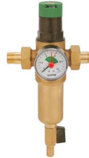
Фильтр со встроенным редуктором давления для предварительной очистки горячей воды от механических примесей - частиц ржавчины, волокон пеньки, песчинок, защиты сантехники, бытовой техники подключенной к водопроводу. Фильтр представляет собой комбинацию промывного фильтра с клапаном понижения давления.
