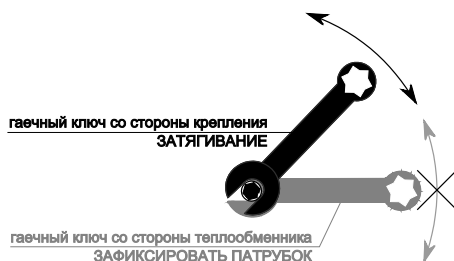
Рис. 5. Подключение к системе подачи теплоносителя
