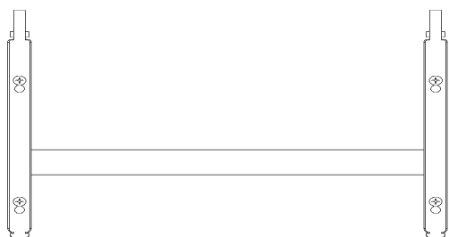
Рис. 1. Установка кронштейна на стене
