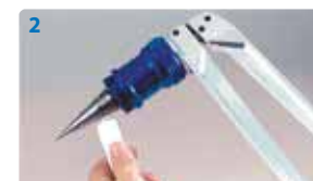
2 Прикрутите к расширительному инструменту насадку-вращатель. Смажьте конус насадки-вращателя графитовой смазкой Uponor
