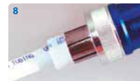
8 Расширяйте трубу с кольцом до тех пор, пока торец трубы не упрется в торец расширительной головки
