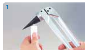
1 Смажьте конус инструмента графитовой смазкой Uponor
