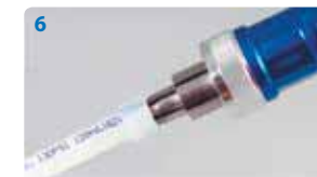
6 Введите сегменты головки максимально глубоко в трубу и расширьте
